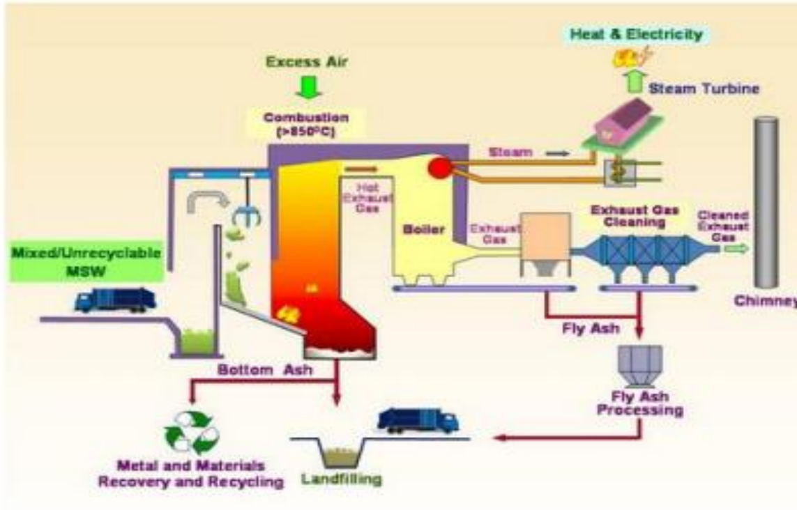
Fig. : Mass burn Incinerator
